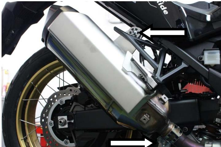
**IT** · Allentare la fascetta, svitare la vite di fissaggio e rimuovere il terminale comprensivo di motore attuatore valvola
