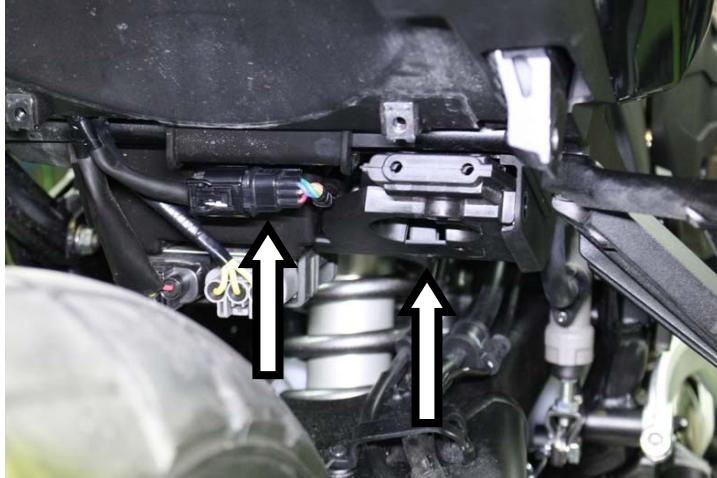
**IT** · Rimontare il motore in moto e riconnettere il cablaggio
