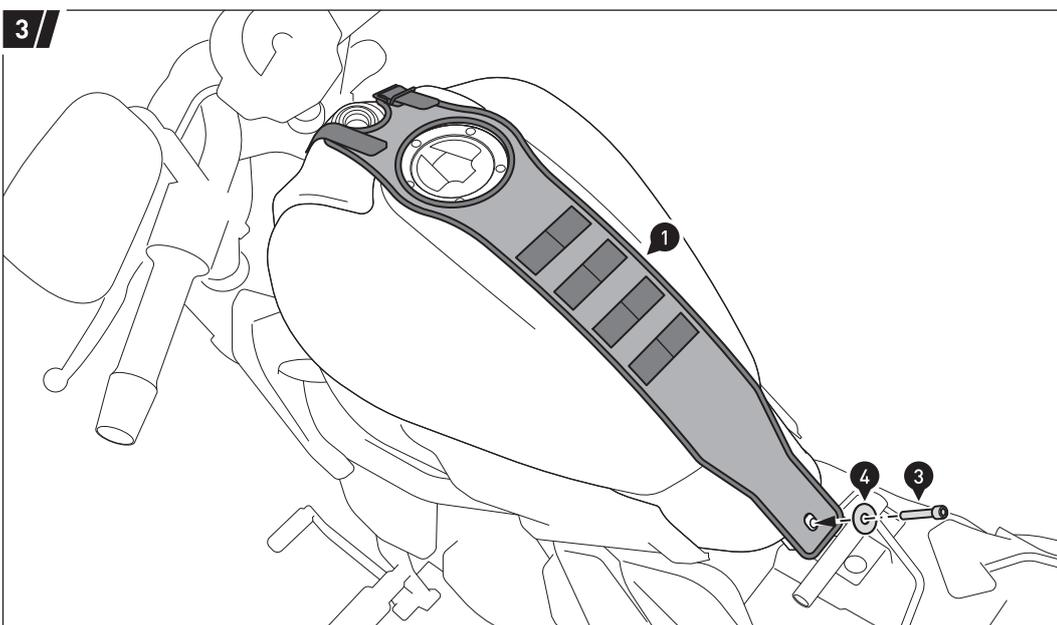
Verschrauben Sie den hinteren Teil des Tankriemens (1) am Tank. Ziehen Sie die Schraube nach Herstellerangaben an.
