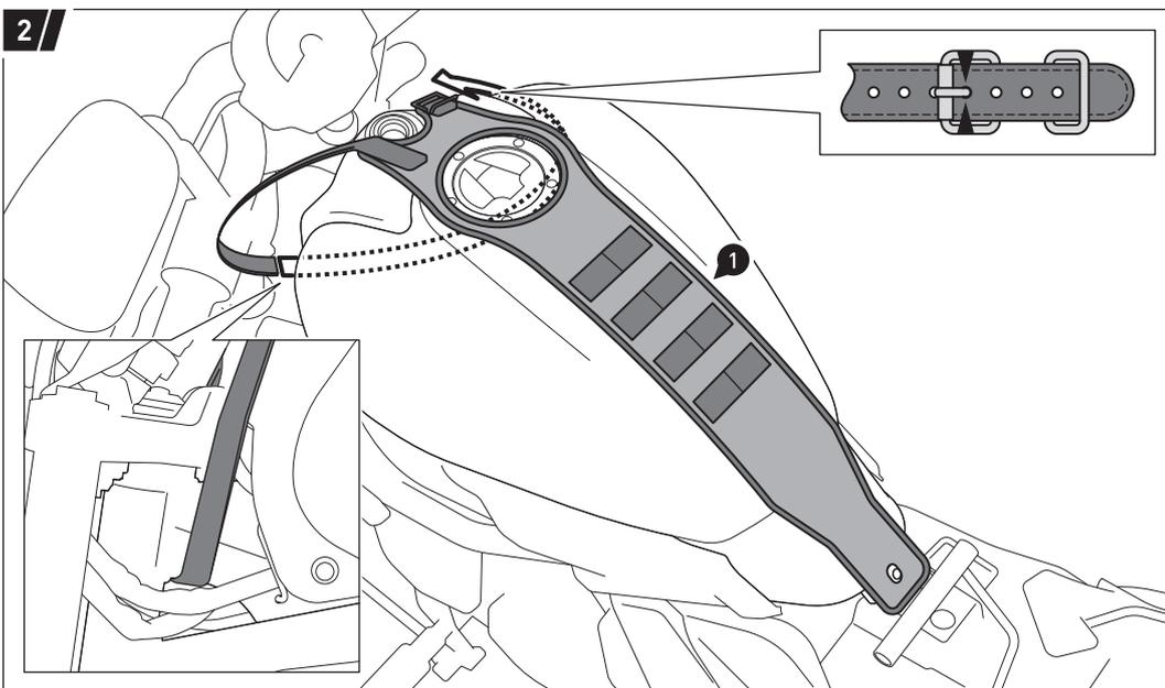
Legen Sie den vorderen Befestigungsgurt des Tankriemens (1) um den Lenkkopf des Fahrzeugs, wie in der linken Detailzeichnung gezeigt (hinter den Kabeln).
